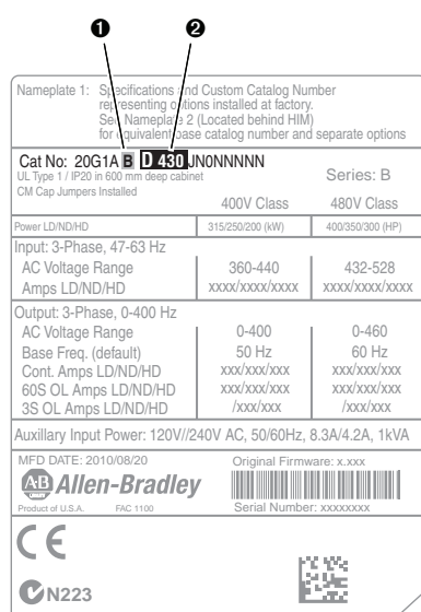
Placa de identificação do inversor 1, carcaças 8 a 10
